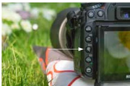
Die Schärfe wird im aufgeklappten Display mit der Lupenfunktion präzise eingestellt.
